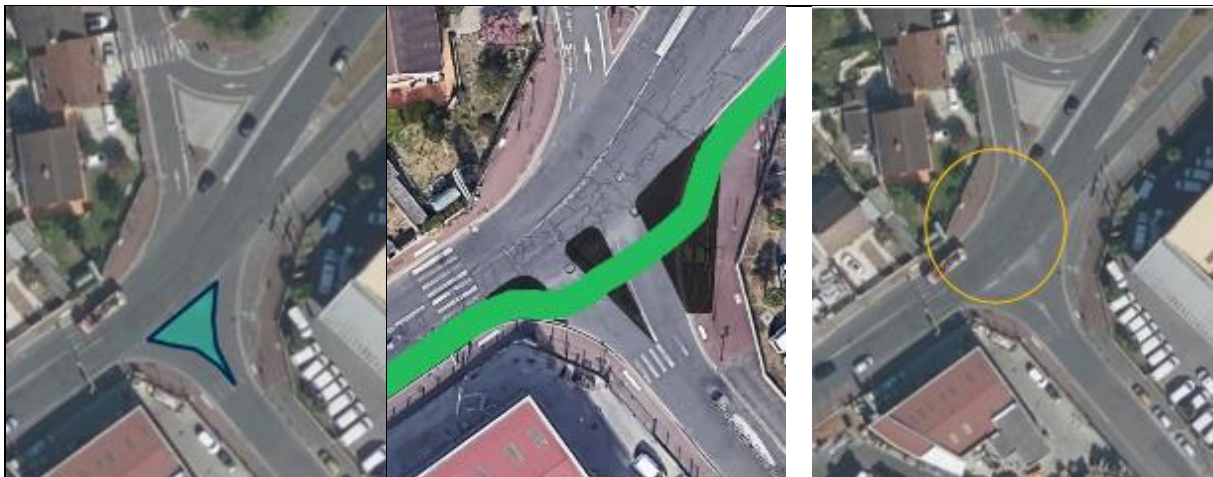
Fig. 42 : régulation dispositif interdisant physiquement le tourne-à-gauche vers ZAE Fig. 42 bis : Option mixte, avec réaménagement partiel du carrefour Fig. 43 : Hypothèse d'un giratoire Sylvie – Belle-Ile Diamètre intérieur, env. 28 m. Légende de la fig. 2 bis : Vert : future piste cyclable av Sylvie – Noir : surévaluation ou plots contraignant la circulation – Bleu : courbure du carrefour réduite – Jaune : liaison Sud/Nord
